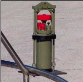
RCM9 de fundo. Correntômetro acústico que mede a velocidade da corrente a menos de 1m do fundo. Alberga também um conjunto de sensores que medem a temperatura, a condutividade, a pressão e a turbidez
