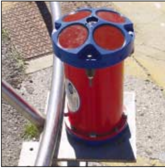
ADCP 300kHz de fundo. Perfilador acústico que mede a velocidade da corrente entre a superfície e o fundo
