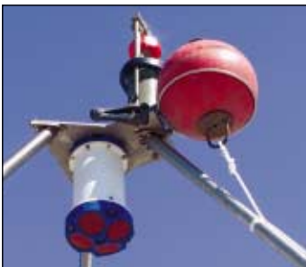
ADCP 1200 kHz e outro RCM9, no topo da estrutura. O primeiro regista o perfil da velocidade na camada limite de fundo e o segundo a velocidade, a temperatura, a condutividade, a pressão e a turbidez, a 5 m do fundo. Vê-se também o flutuador do sistema de recuperação
