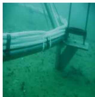
Da esq. para a dir.: saída do cabo-guia de dentro do fato de surf; mergulhador inspeccionando a estrutura; pormenor do enrolamento do cabo de recuperação em volta do travamento inferior da estrutura e o suporte do RCM9 de fundo. Estas imagens foram obtidas pela equipa de Mergulhadores Sapadores da Armada
