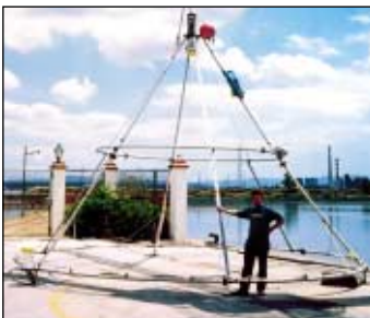
CORSED MK2 («Matos Kaldas 2.ª versão»). Apesar da sua forma e dimensão ser resultado de requisitos para o bom funcionamento dos perfiladores acústicos da corrente, a estrutura pode constituir uma plataforma para qualquer outro sensor físico-químico
