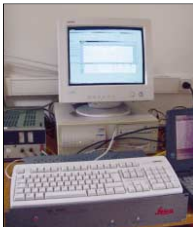
Leica MX 9320 ligado a um computador para gravação de dados
