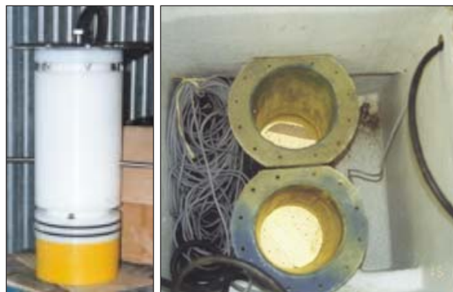
Fig. 9 - Aspecto dos transdutores e sua instalação
