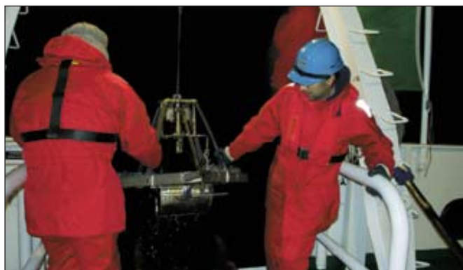
Recuperação do colhedor de sedimentos superficiais a bordo do NRP Auriga
