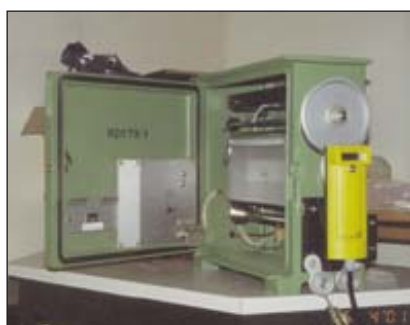
Fig. 12 – Marégrafo digital associado a marégrafo analógico
