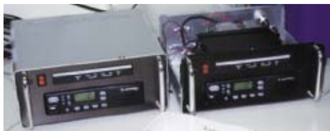
Fig. 5 - Sistema de ligação de dados para DGPS
