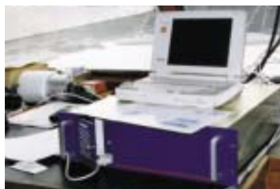
Fig. 6 - Aspecto de funcionamento de um Seapath 200
