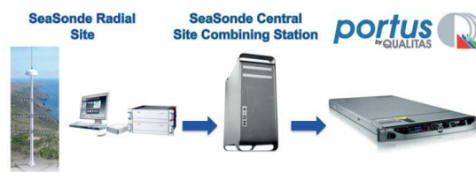
Fig. 5. Fluxo de informação desde a estação Radial até ao servidor PORTUS.
