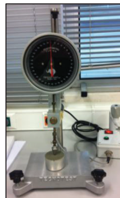
Fig. 3 – Cone penetrómetro utilizado nos ensaios.
