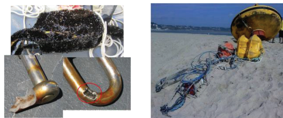
Fig. 3. Imagens de corrosão de materiais em aço, excesso de incrustação biológica e derivas das boias por tempestades ou intervenções humanas.
