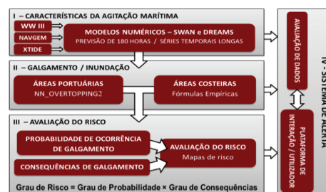
Fig. 1. Esquema do sistema HIDRALERTA
