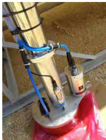
Fig. 3. Sonda multifeixe EM2040C e sistema inercial MRU-5 acoplado.
