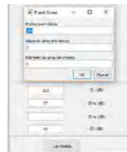
Fig. 6. Menu de introdução dos parâmetros do sonar. O utilizador pode também optar por introduzir diretamente o valor estimado de DI para o sonar (DI rx).
