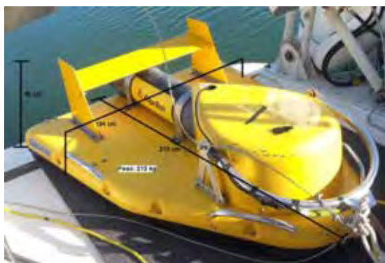
Fig. 2. Peixe do sistema combinado Chirp Sonar/Side Scan Sonar Edgetech SB-512i.
