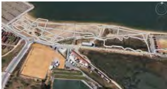
Fig. 1. Trajetória obtida pelo software RTKLIB para o percurso BALD.
