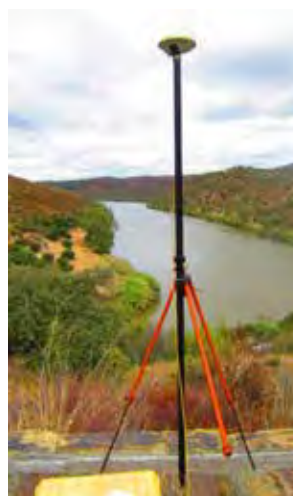
Fig. 2. Coordenação GNSS de um ponto de apoio.
