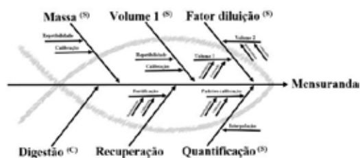
Fig. 2. Identificação das fontes de incerteza consideradas na aplicação da abordagem diferencial. (S) – Fonte de incerteza simples; (C) – Fonte de incerteza complexa.
