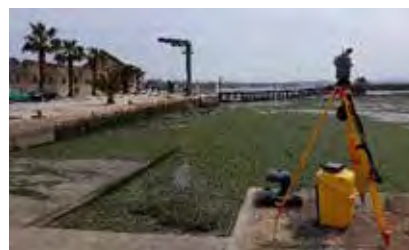
Fig. 6. LT na BHA com o Trimble SX10.
