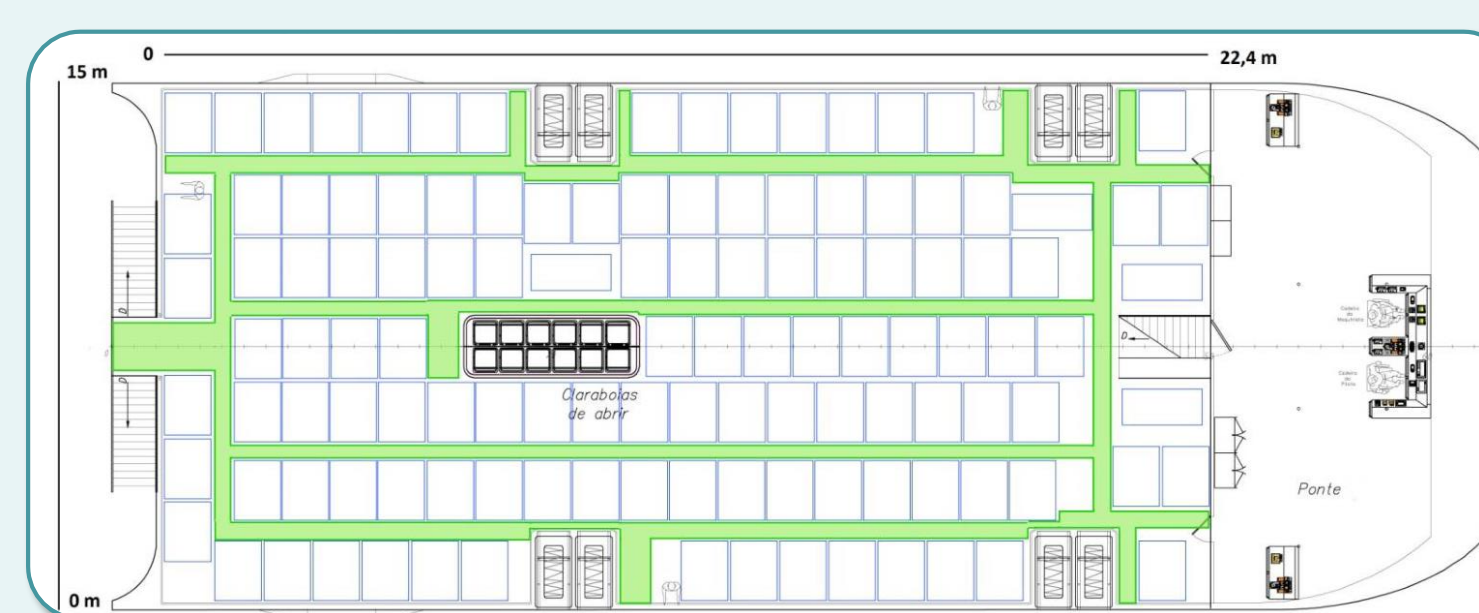
Fig. 4. Disposição dos módulos FV no convés do solário do navio.
