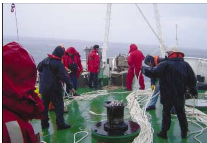
Colocação da amarração, à chuva
