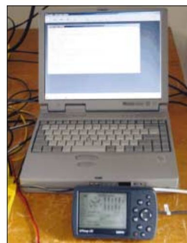
Garmin GPSMap 176 ligado a um computador portátil para gravação de dados
