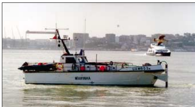
Embarcação UAM Atlanta, com o transdutor do sistema multifeixe instalado à proa
