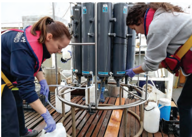
Figura 2 – Recolha de amostras de água de garrafas Niskin (Sistema Rosette).
