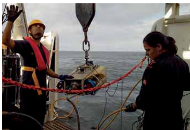
Colocação do ROV na água
