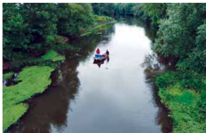
Embarcação de sondagem dos bombeiros voluntários de Águeda com sondador de feixe simples em sondagem.
