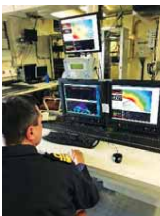
Operação do sondador multifreixo.
