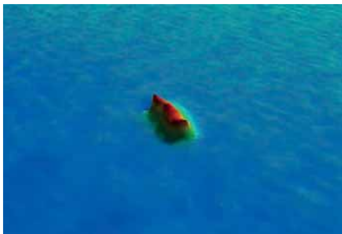
Deteção da embarcação naufragada através do sondador multifeixe
