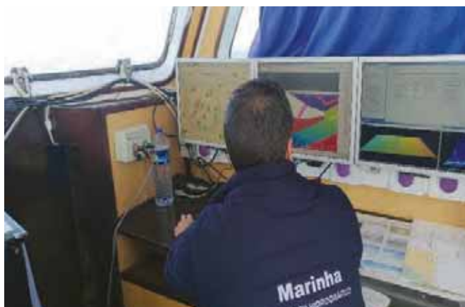
Hidrografo a adquirir dados multifeixe a bordo de embarcação de sondagem.
