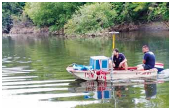
Embarcação de sondagem dos bombeiros voluntários de Águeda com sondador de feixe simples em sondagem.
