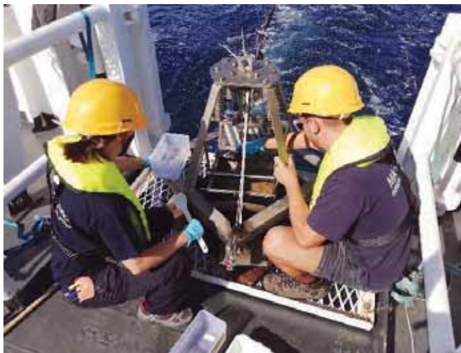
Figura 2 - Colheita de sedimentos a bordo do NRP Auriga .
