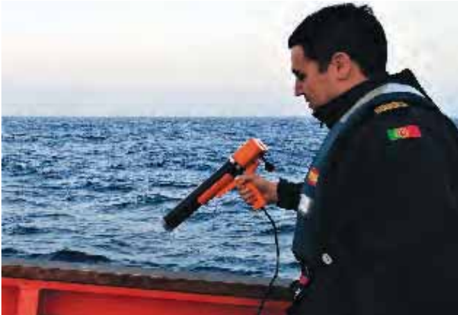
Execução de um perfil de temperatura com um expendable bathythermograph (XBT).
