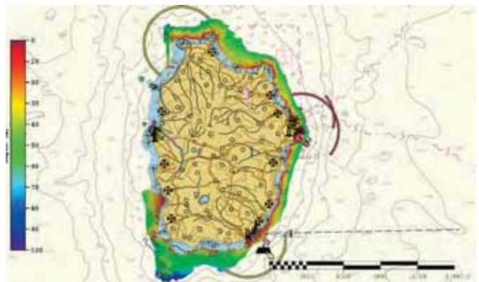
Cobertura batimétrica realizada na ilha das Flores com o sondador multifeixe.
