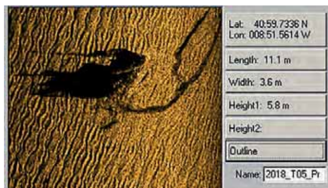
Deteção da embarcação através do sonar lateral
