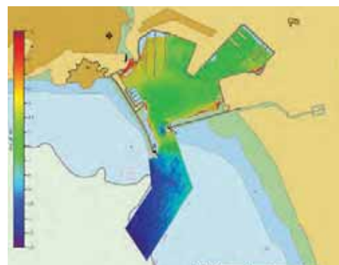
Cobertura batimétrica realizada com o sondador multifeixe.
