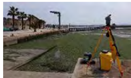
Fig. 6. LT na BHA com o Trimble SX10.
