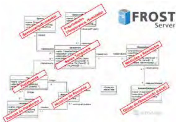
Fig. 2. Modelo de dados do OGC SensorThings sobreposto com a nomenclatura utilizada na plataforma MarRISK.
