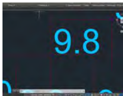
Fig. 3. O DOT (bloco azul escuro) coincide com a posição da sonda (representado na figura com por uma cruz); o valor numérico da sonda é um bloco de texto único representado ligeiramente à direita da sonda.
