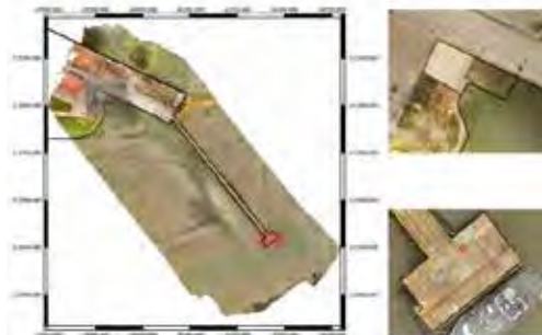
Fig. 8. Sobreposição do levantamento topográfico por GNSS à ortofoto produzida.
