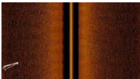
Fig. 2. Exemplo de dados obtidos com sonar de varrimento lateral a bordo de um LAUV
