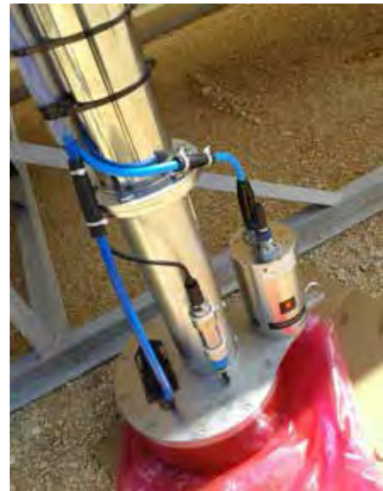
Fig. 3. Sonda multifeixe EM2040C e sistema inercial MRU-5 acoplado.
