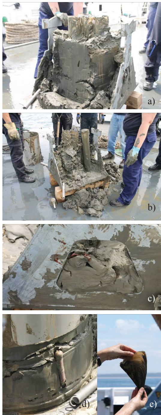
Fig. 4. Fotos dos sedimentos silto-argilosos, colhidos com o box-corer, a bordo do “NRP Gago Coutinho”; a) e b) panelão com a amostragem verticais (4 tubos de PVC); c) d) e e) macrofauna bântica encontrada; Anelídeos (poliquetas); Priapulida (Penis worm) e Molusco bivalve ( Pinna fragilis ), responsáveis pela bioturbação do sedimento.
