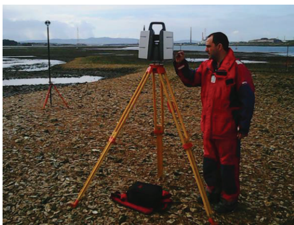
Fig. 1. Operação da ScanStation P40 da Leica Geosystems no local do trabalho.
