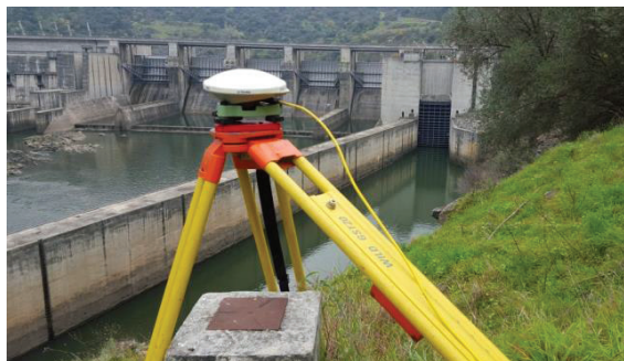
Fig. 2. Coordenação de um ponto de apoio na barragem da Valeira a partir de observações GNSS.
