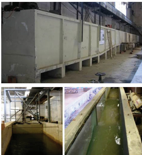
Fig. 1. Vista lateral do canal (cima), gerador de ondas (esquerda) e vista de cima do canal (direita).
