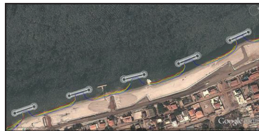
Fig. 6. Linha de costa inicial (azul) e as previstas a obter, após 1 ano (verde), 5 anos (amarela) e 10 anos (vermelha).
