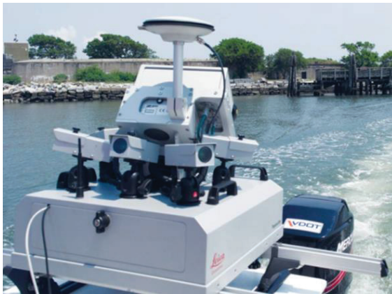
Fig. 7. Exemplo do sistema Mobile Mapping Leica Pegasus, instalado numa embarcação (XYHT, 2016).
