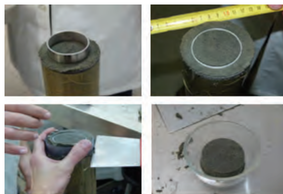
Fig. 3 Seccionamento de 2 em 2 cm dos testemunhos verticais.
