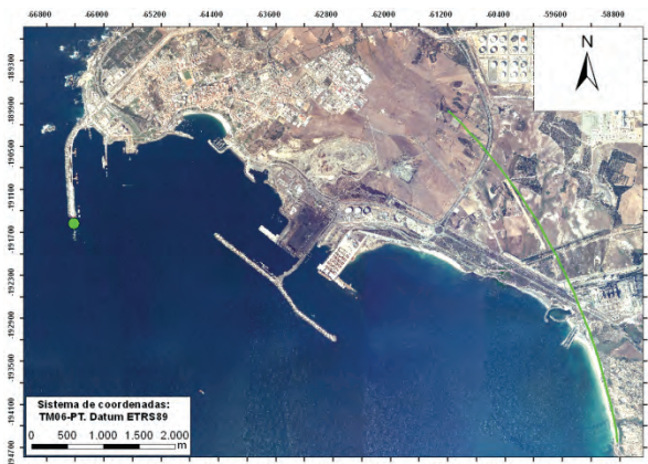
Fig. 5 – Ajuste da configuração parabólica (a verde) com o ponto de difração (a verde) nas imediações da ponta do molhe Oeste.
