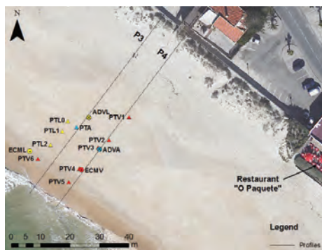
Figura 8 – Localização da instrumentação utilizada ao longo de dois perfis na praia de Faro.
