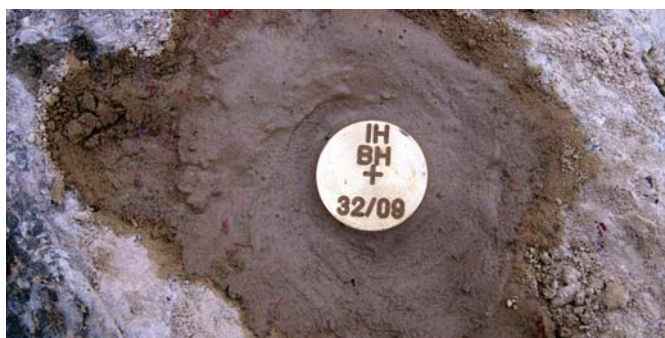
Fig. 8 - Marca de nivelamento "IH BH 32/09"
