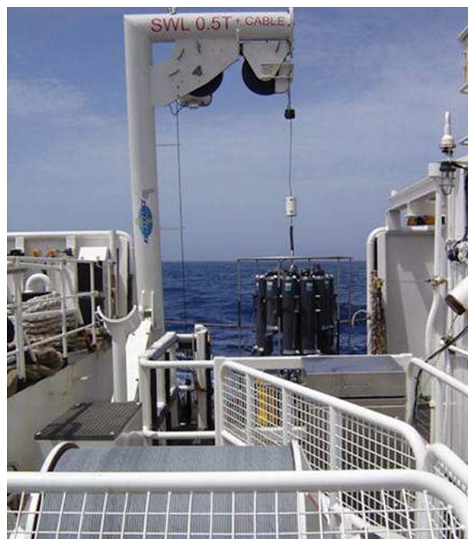
Fig. 2 À esquerda, o sistema CTD durante a fase de início de mais uma estação CTD. São visíveis na imagem a sonda multipâmetro CTD Neil Brown (cilindro metálico na base e sensores acoplados), o perfilador acústico de corrente L-ADCP (cilindro amarelo situado na base) e o sistema de colheita de amostras de água, dotado de 12 garrafas de amostragem. À direita, aspecto geral do guincho CTD instalado no NRP Almirante Gago Coutinho.
