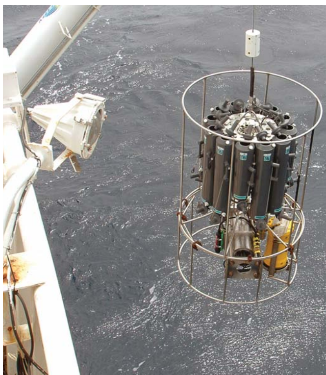
Fig. 2 À esquerda, o sistema CTD durante a fase de início de mais uma estação CTD. São visíveis na imagem a sonda multipâmetro CTD Neil Brown (cilindro metálico na base e sensores acoplados), o perfilador acústico de corrente L-ADCP (cilindro amarelo situado na base) e o sistema de colheita de amostras de água, dotado de 12 garrafas de amostragem. À direita, aspecto geral do guincho CTD instalado no NRP Almirante Gago Coutinho.
