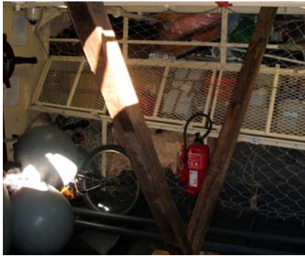
Escoramento definitivo, efectuado durante um exercício de BIR Alagamento
