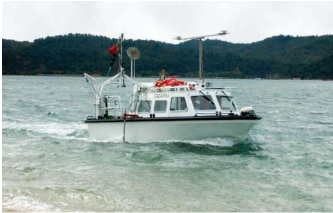
Embarcação Cagarra em sondagem multifeixe
