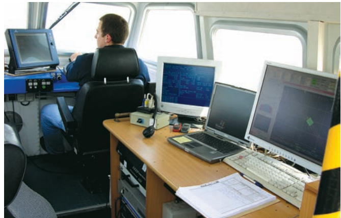
Aspecto do interior da embarcação Cagarra em execução de sondagem com multifeixe
