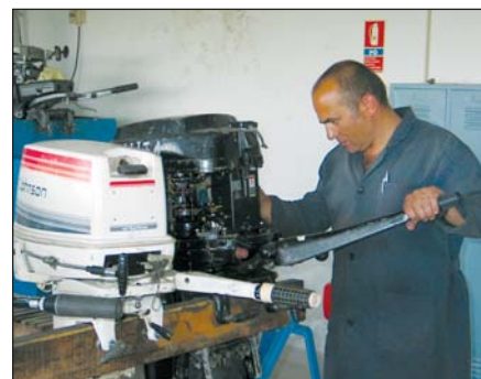
Reparando motor fora de borda
