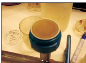
Amostras de águas colhidas nos rios e aspecto dos filtros com sedimentos em suspensão, após filtração no laboratório de campanha em Matosinhos
