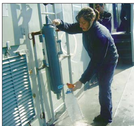
Sequência de uma estação CTD e colheita de águas no estuário do Minho, a bordo do NRP Rio Minho
