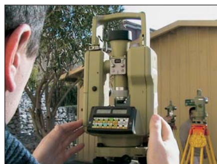
Instrução prática de instrumentos de medição de ângulos e distâncias (estações totais)
