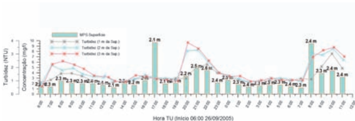
Figura 10 – Relação entre a concentração de MPS nas amostras colhidas junto à superfície (os números acima das barras indicam a profundidade real da colheita) e a turbidez nos níveis mais superficiais do perfil, durante o período de marés-mortas no estuário do rio Minho (Setembro 2005).
