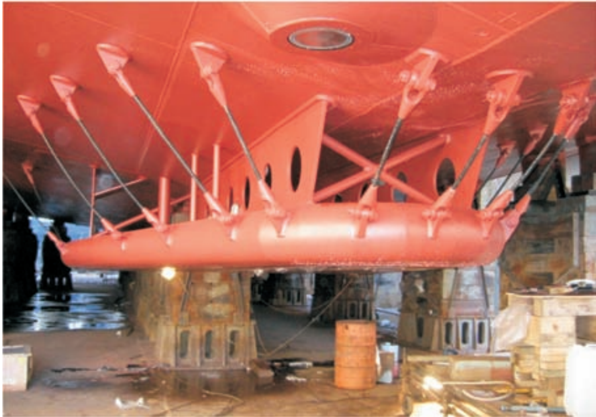
Figura 3 – Gôndola para instalação dos transdutores dos SMFs. Imagem obtida com o navio na doca seca do Arsenal do Alfeite em Dezembro de 2006.
