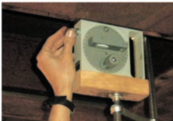
Figura 4 – Nível de artilharia utilizado para determinar a inclinação do sensor de movimentos.
