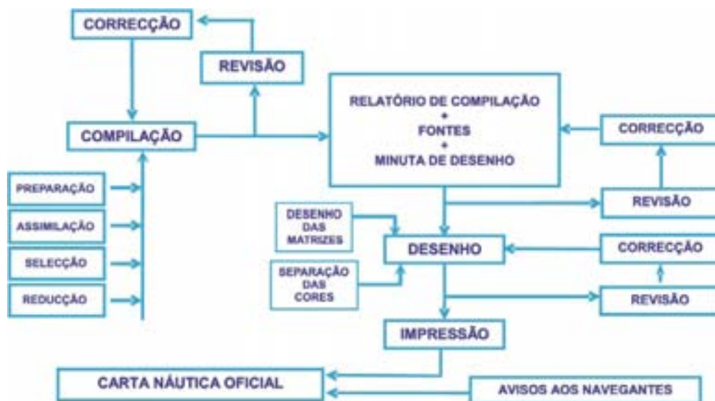
Figura 7 – Construção de uma CNO
