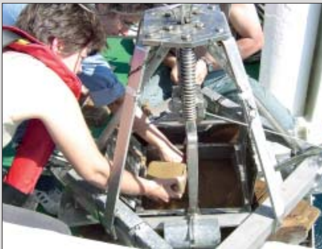
Recolha de amostra de fundo, utilizando um colhedor de sedimentos Smith-McIntyre
