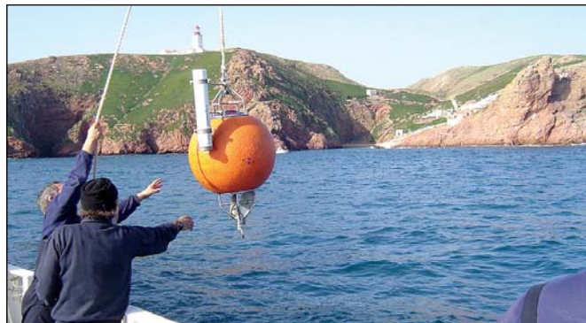
No fundeadouro da Berlenga, em testes ao flutuador do ADCP
