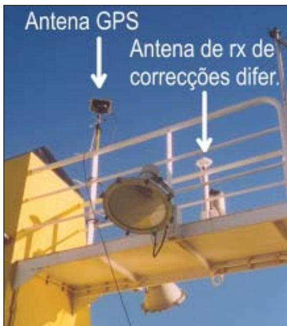
Fig. 1 – Antenas instaladas no NRP «Auriga»
