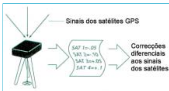
Fig. 2 – Estação de Referência a gerar correcções diferenciais
