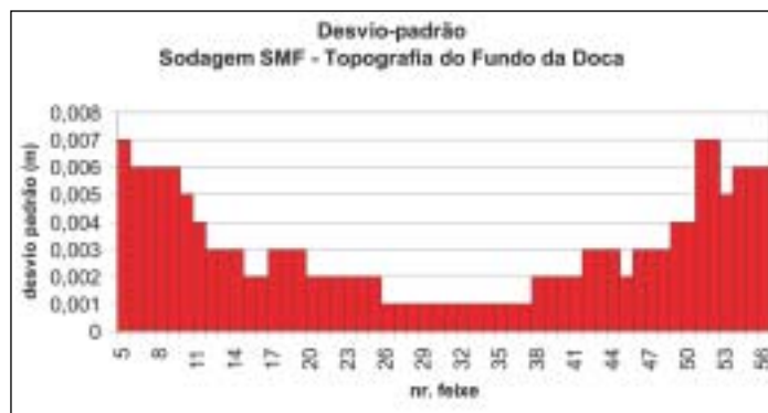
Fig. 6 – Desvios padrão da comparação dos dados de sondagem com o fundo plano da doca (apresentada na fig. 5)
