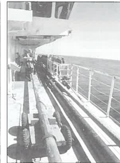
Tubos de penetração com 50 m de comprimento, prontos a serem acoplados no restante dispositivo de colheita
